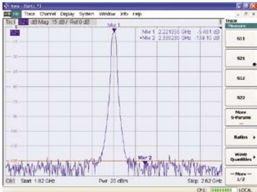
Динамический диапазон между тестовыми портами при полосе ПЧ 10 Гц
