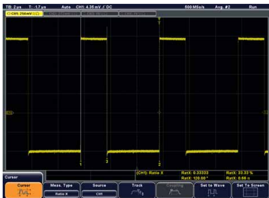
Курсор для определения коэффициента заполнения импульсного сигнала
