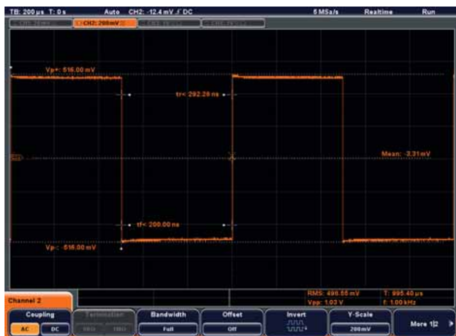
QuickMeas: автоматическое измерение и отображение в графической форме нажатием одной кнопки.
