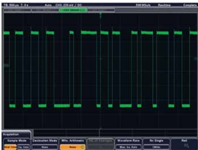
Режим Smooth позволяет сгладить (справа) шумные неперiodические сигналы (слева)
