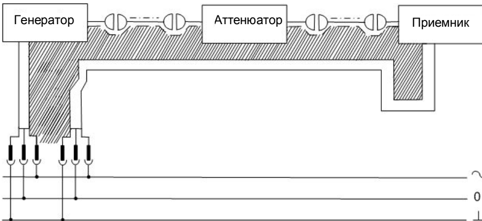
Рис. 7-2 – Снижение индукционного помехового напряжения
