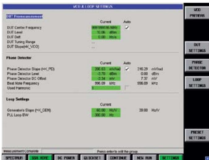
Типовое измерение фазового шума по методу фазового детектора: отображается частота сигнала, уровень и остаточная модуляция ЧМ/ФМ.
