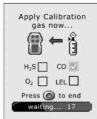
5. Сначала газоанализатор выполняет тест на газ. После обнаружения достаточного количества газа напротив каждого обнаруженного газа будет показано
