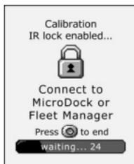
4. При появлении следующего сообщения установите калибровочную крышку и подайте калибровочный газ со скоростью 250–500 мл/мин. См. **Подсоединение баллона с газом к газоанализатору**.
