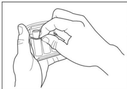
6. Извлеките отработанные батареи. Верните выталкиватель в исходное (горизонтальное) положение. Убедитесь, что выталкиватель вошел в контакт с фиксатором.
